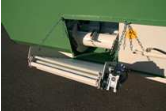
Abbildung 15: Austrage-Kettenband mit geöffnetem Austrageschieber
