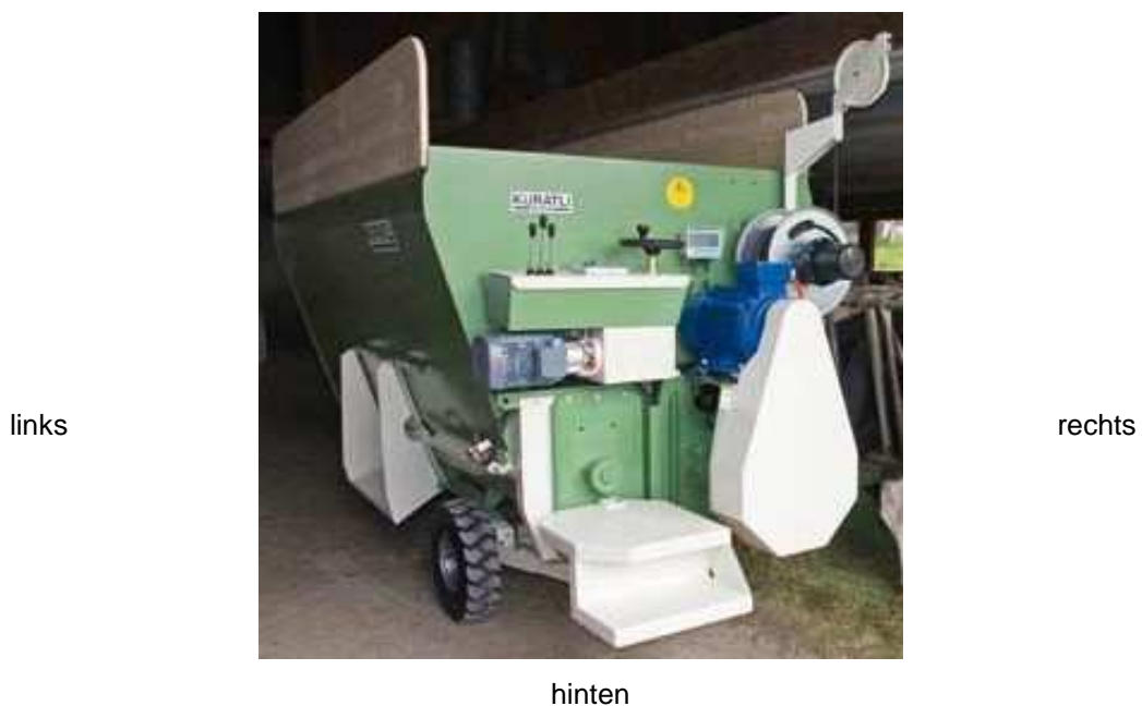
Abbildung 1: Rückseite der Maschine mit Bedienerplattform, Steuerpult und Kabeltrommel
