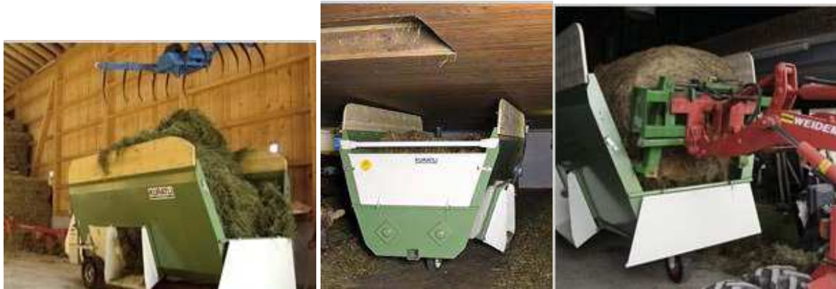
a) Abbildungen 4: Beladen der Maschine a) mittels Heukran b) händische Beladung vom Hauboden durch den Decken-Durchlass c) mit mobilen Hoftrac
