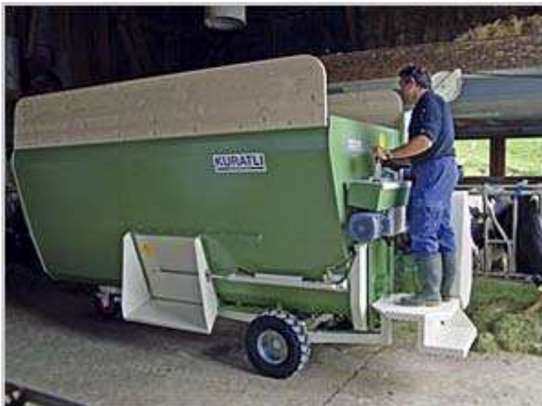
Abbildung 3: Während des Austragens des Futters befindet sich der Bediener auf dem dafür vorgesehenen Podest.
